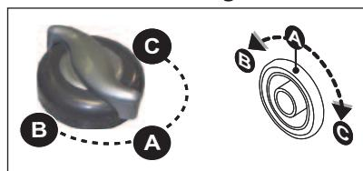
Certains modèles sont équipés d'un sélecteur permettant de personnaliser les prestations de l'hydromassage en déviant l'eau parmi les différents systèmes de jets (position **A** (Combo), **B** ou **C**). Pour une filtration de l'eau parfaite - et pendant le traitement de « superchloration » ou « choc » - laisser la vanne en position **A** lorsque le spa est couvert.
