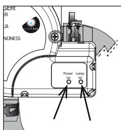
**Nota:** il sistema CLEARRAY funziona solamente quando la pompa getti 1 funziona in bassa velocità (filtrazione, ecc). Trascorso un anno, la lampada deve essere sostituita. Se il timer UV è stato programmato correttamente (vedi cap. relativo), alla scadenza del tempo previsto sul display apparirà il messaggio "blb", segnalando così la necessità d' installare una nuova lampada UV e reimpostare quindi il timer.
