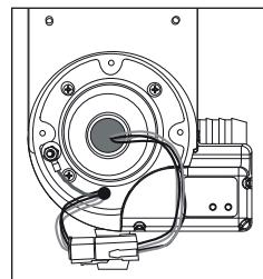
3- Débrancher le connecteur de l'ampoule UV (6) de l'alimentation (4)
