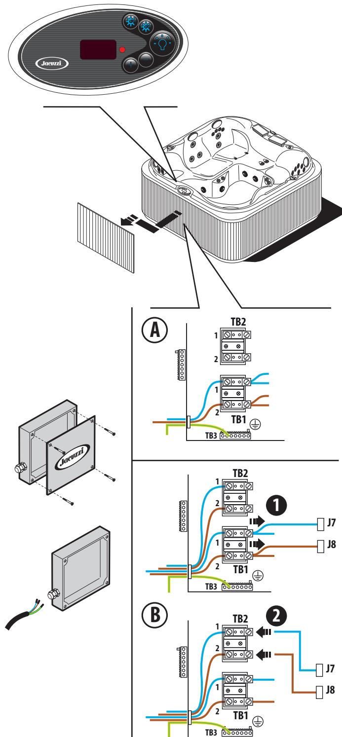
■ En fonction du modèle de spa effectuer le branchement sur le bornier comme indiqué sur les schémas correspondants.
