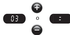
Se sullo schermo LED viene visualizzato "U", premendo il pulsante Pompa 1 il sistema di sanitizzazione passerà da "U" a "O3" dopo di che si uscirà dal menu di programmazione.
